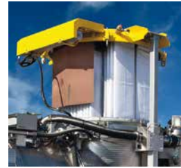
Trockensaugfilter mit Filterhubsystem
