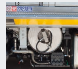
Installation d'eau haute pression
