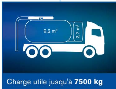
Charge utile jusqu'à **7500 kg**
