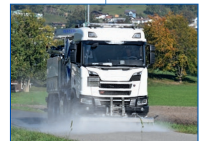
Strassenreinigung mittels pneumatisch schwenkbarem Strassenwaschbalken.
