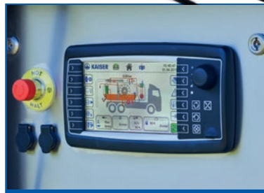
Touch Screen Bedienpult mit graphischer Darstellung der Arbeitsprozesse. Bewährtes KAISERteleservice Fernwartungssystem.
