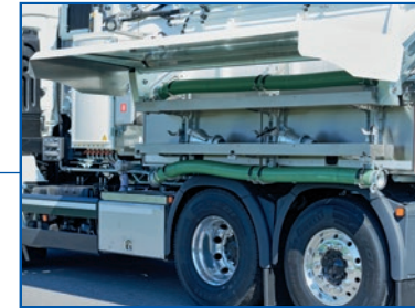
Hydraulisch abklappbares Ablagesystem mit viel Stauraum und flexibler Nutzung.
