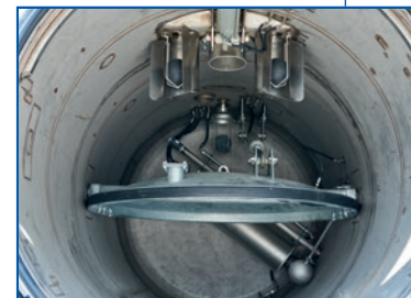
Hydraulisch klappbare Trennwand. ROTOMAX Wasserrückgewinnungssystem.
