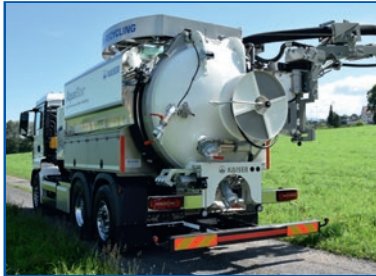
Ein entkoppelbarer Zusatzhaspel erhöht die Flexibilität im Arbeitsbereich.
