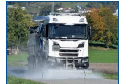
Strassenreinigung mittels pneumatisch schwenkbarem Strassenwaschbalken.
